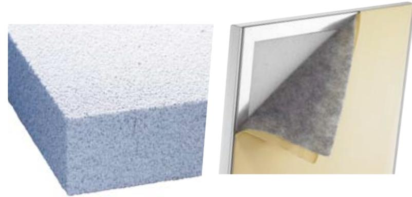
Die besondere Charakteristik des Gipsschaums im Vergleich zu anderen Absorptionsmaterialien liegt in seiner Beschaffenheit aus dem natürlichen Rohstoff Kalk, der als Gipsstaub - mit einem Polymer aufgeschäumt - zu Gipsschaumplatten verarbeitet wird.
