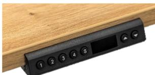
Das Komfort-Bedienelement bietet 4 Speicherplätze für Arbeitshöhen. Fahren Sie mit der Auf-Ab-Taste den Tisch in die gewünschte Position, halten Sie anschliessend die Taste «S» und den gewünschten Speicherplatz (Taste 1,2,3 oder 4) für ca. 3 Sekunden gleichzeitig gedrückt um die Höhe zu speichern.
